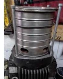
El bobinado se encuentra en buen estado, no está quemado, sin embargo tiene mucha oxidación, se le debe realizar una buena limpieza.
